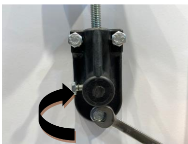
14) Apertar o parafuso que fixa a regulação do Volante Superior com o auxílio de uma Chave de Boca 11.
