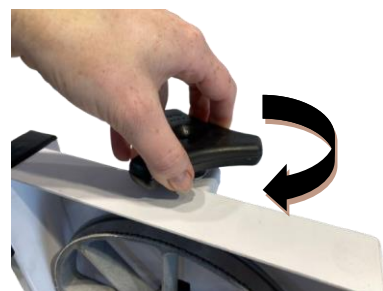
12) Girar o Manípulo Esticador da Lâmina no sentido horário até alcançar o ajuste da Lâmina de Corte desejado.
