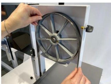
10) Encaixar a Lâmina de Corte no Volante Superior.
