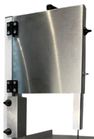
13) Fechar as portas de acesso aos Volantes e ligar o equipamento para verificar a correta regulação da Lâmina de Corte.
