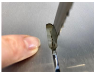
8) Encaixar a Lâmina de Corte no Batente.
